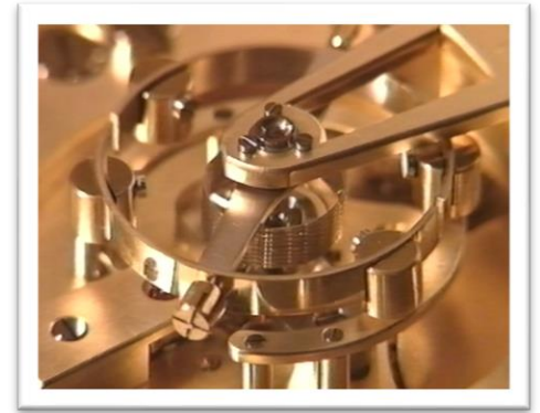
Le premier balancier monométallique avec un spiral en élinvar chronographe Zenith en 1916.
