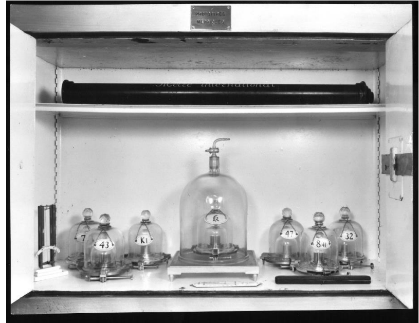
L'ancien dépôt des prototypes métriques. L'étalon international du mètre (partie haute). Le prototype international du kilogramme avec ses six témoins.
